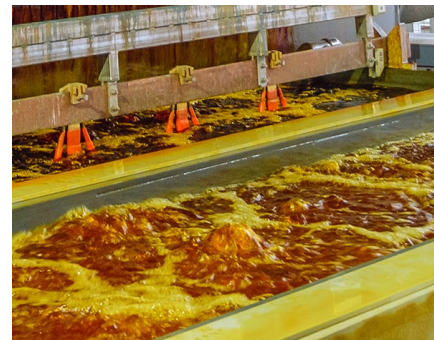
Billede af hårdforkromningsbad fra en udenlandsk virksomhed. Billedet afspejler ikke danske arbejdsforhold. Foto: Gettyimage
